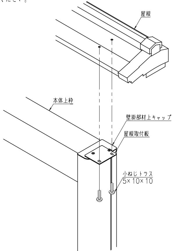
※図は壁掛部材上キャップの場合。壁掛部材下キャップの場合は〈屋根なしの場合〉と同様に取り付けてください。
