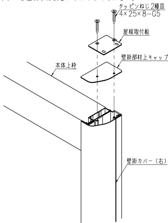
→オプション品の落ち葉よけネットを取り付ける場合は、屋根を取り付ける前に端部キャップを取り付けてください。
