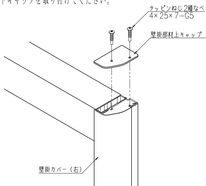
※図は壁掛部材上キャップの場合。壁掛部材下キャップの場合も同様に取り付けてください。
